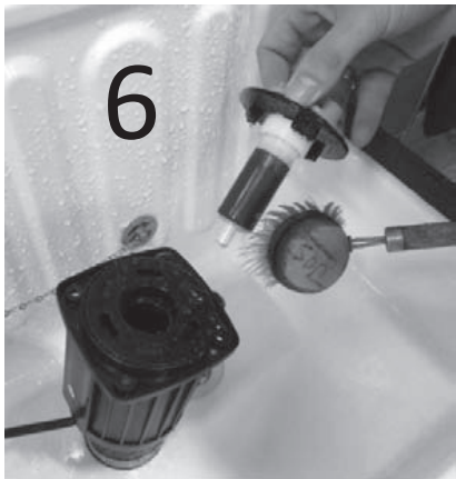
Rotor met water en borstel schoonmaken
