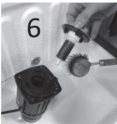
Rotor mit Wasser und Bürste reinigen
