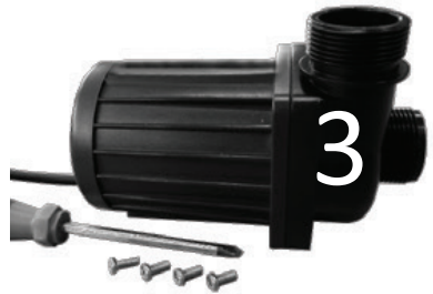
Schroeven van pomphuis verwijderen
